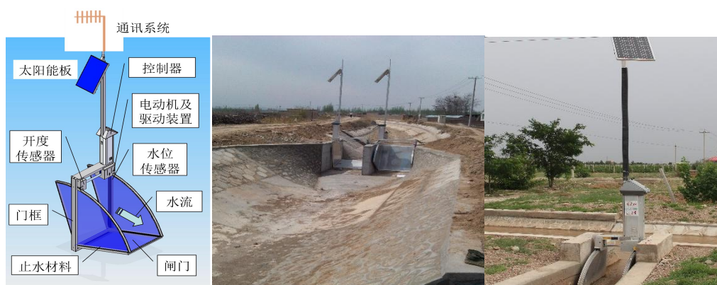
图 1.2.4-5 甘城子灌区已安装进口自动量测水设施现状
