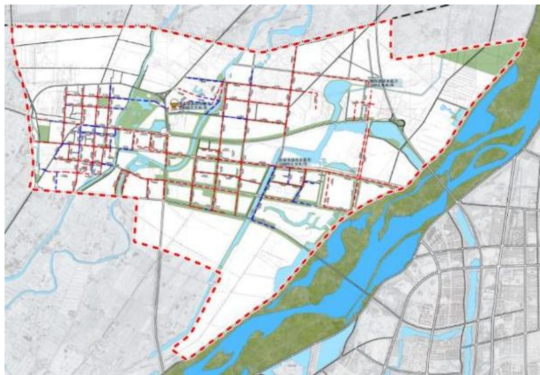
图 2-18 暴雨重现期 0.5 年管道承压示意图
