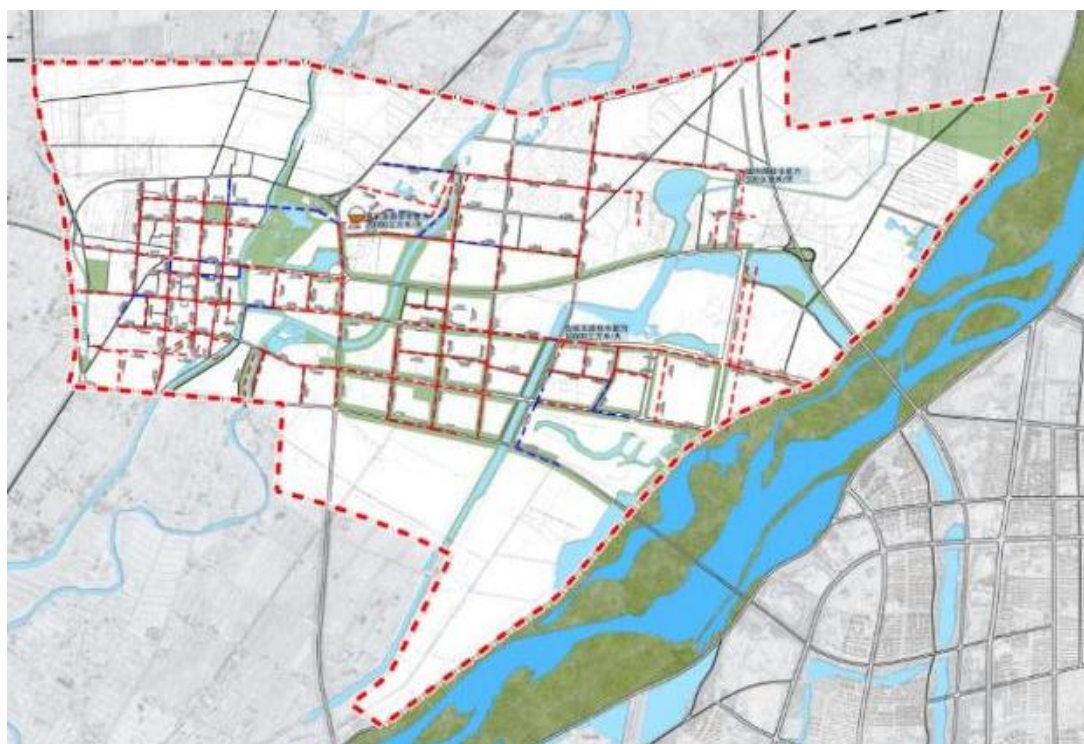
图 2-22 暴雨重现期 5 年管道承压示意图
