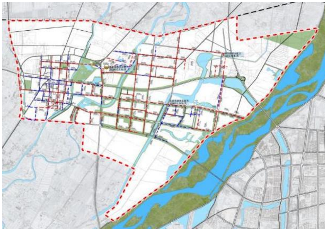
图 2-18 暴雨重现期 0.5 年管道承压示意图
