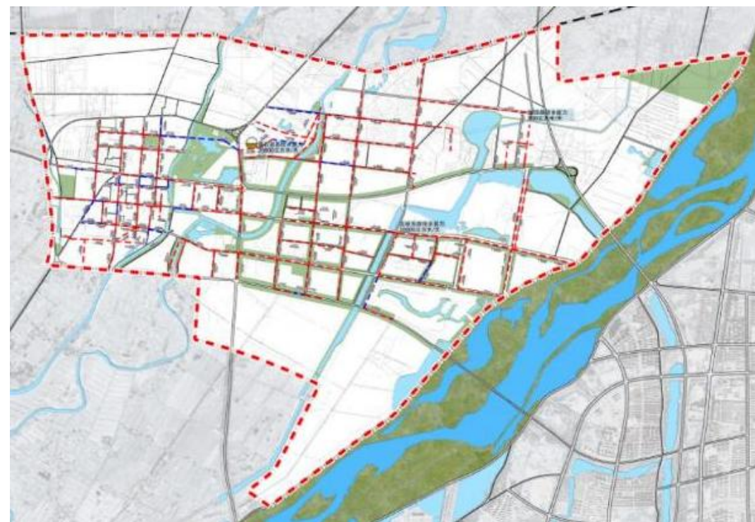
图 2-20 暴雨重现期 2 年管道承压示意图
