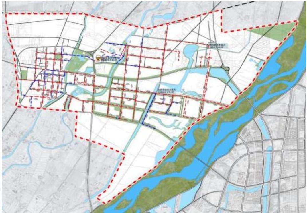
图 2-18 暴雨重现期 0.5 年管道承压示意图
