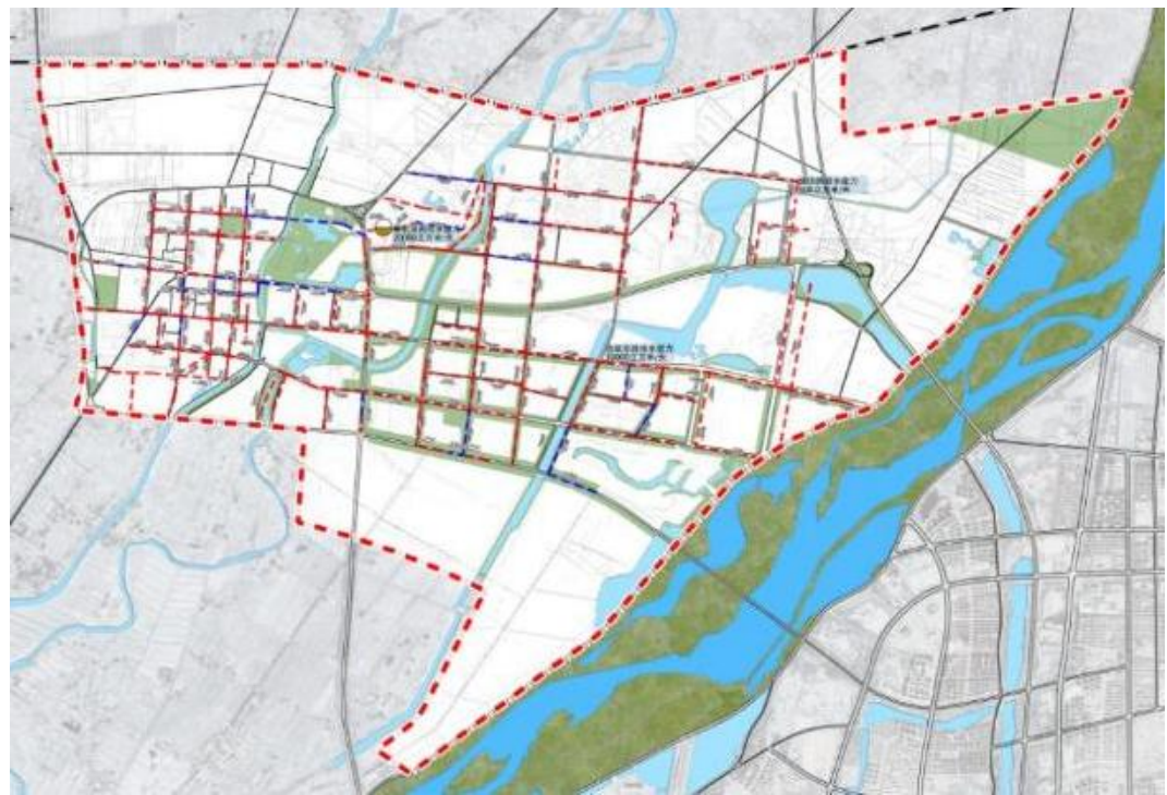
图 2-20 暴雨重现期 2 年管道承压示意图
