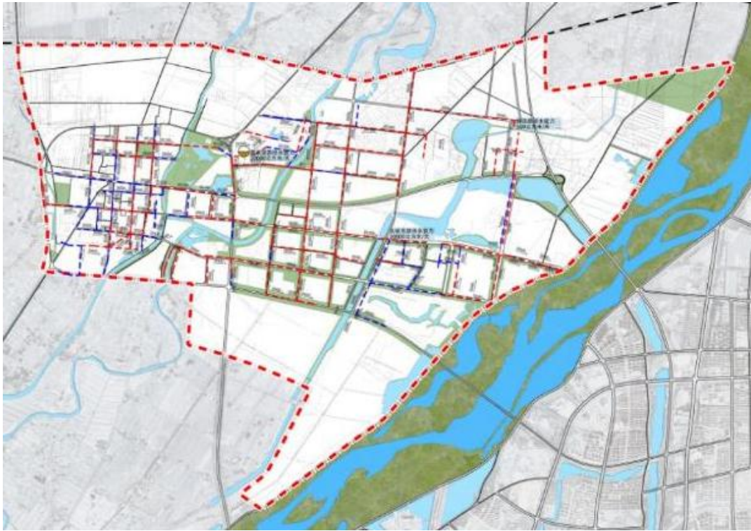
图 2-18 暴雨重现期 0.5 年管道承压示意图
