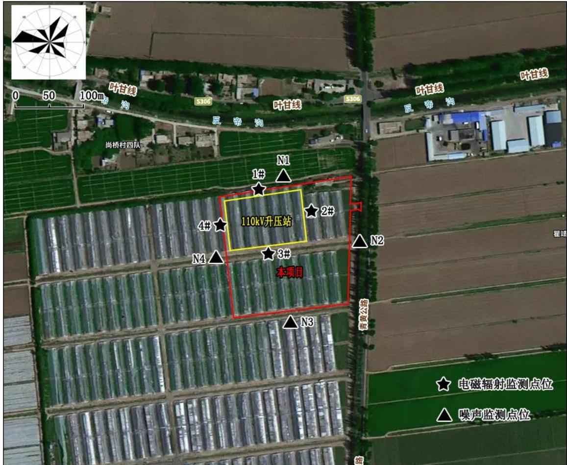
图 3-7 本项目噪声、电磁环境现状监测点位示意图
