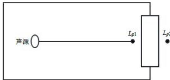
图 21 室内声源等效为室外声源图例
